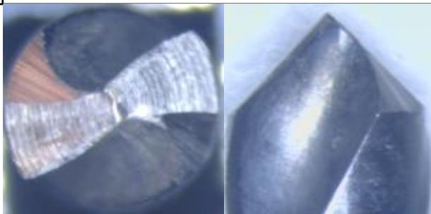
結論：先於鋼筋鑿穿一孔後可降低水泥鑽頭貫穿鋼筋時間，
